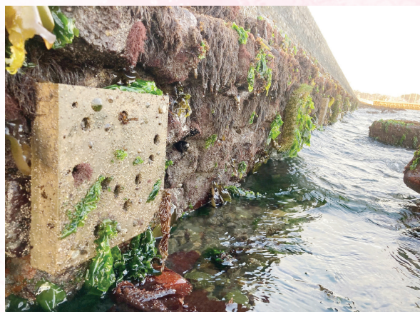
Hình 2. Một tấm ốp thí nghiệm thuộc dự án Living Seawall pilot được triển khai trong thí nghiệm tại kè chắn biển liền kề với bến cảng San Francisco Marina.
