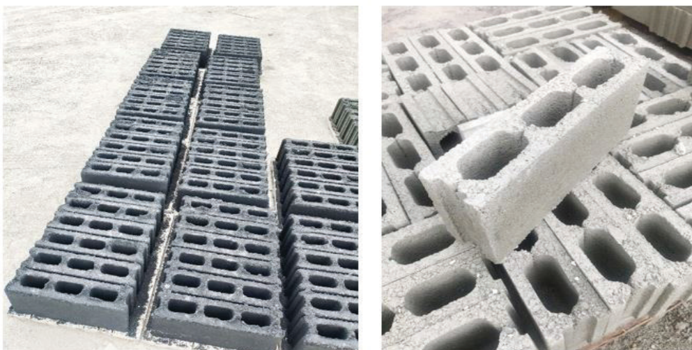
Hình 3. Sản phẩm gạch tái chế của nhóm nghiên cứu, với cấu tạo có 3 lỗ trên nền hạt carbon đen
