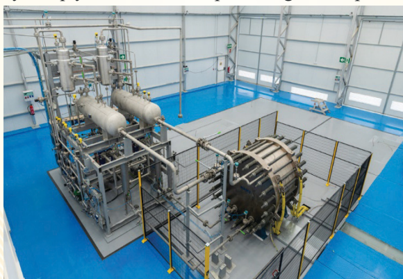
Máy điện phân kiềm điều áp do Nordex chế tạo. Ảnh: Nordex
